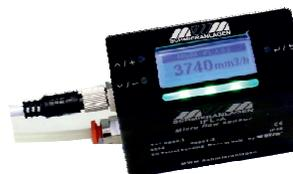
Questo sensore consente di rilevare immediato di una microportata. L'IFL-A si basa sulla tecnologia dell'interferometria laser ed è progettato per misurare con estrema precisione portate estremamente basse, fino a poche gocce all'ora. Il sensore IFL-A garantisce il rilevamento efficace e istantaneo di microportate minime. Applicazione: monitoraggio di microportate e dosaggio di piccoli volumi di fluido.
