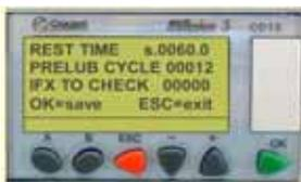
**ZYKLUSZEIT:** Um die Förderfrequenz des Dosierelements zu ändern wird diese einfach am PLC geändert und der neu eingestellte Wert wird dann auf dem Display überprüft. Die PLC steuert jetzt automatisch den Schmierzyklus, um die Spindel mit der korrekten Ölmenge zu versorgen.
