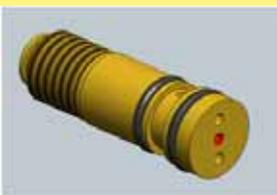
**DOSIERELEMENTE:** Der patentierte MWM Mischblock besteht aus einem hochgenauem Dosierelement, 100 % geprüft, mit engem Toleranzbereich. Zum Beispiel hat das 10 mm<sup>3</sup> Dosierelement eine Toleranz von max -0% +20% zum Nominalwert. Dosierelemente sind mit Fördermengen von 10, 20 oder 30 mm<sup>3</sup> erhältlich.
