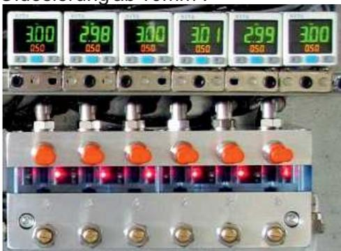
Der Öl+Luft Strom ist durch präzise elektronische optische Sensoren überwacht, die Bildvariationen in Ölmenge und Luftstrom erfassen können und ein Signal dem PLC des Überwachungsystems liefern. Das Mischgerät MVF-A ist in
