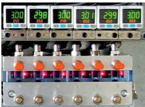
Il flusso A+O viene costantemente monitorato da precisi sensori ottico-elettronici che possono rilevare variazioni nelle quantità di lubrificante e portata di aria segnalandole immediatamente al PLC del sistema di controllo. Il miscelatore tipo MVF-A è disponibile nelle versioni da 1 a 6 uscite.
