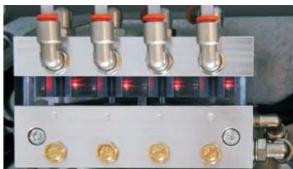
Il flusso A+O viene costantemente monitorato da precisi sensori ottico-elettronici che possono rilevare variazioni nelle quantità di lubrificante e portata di aria e segnalano immediatamente al PLC della centralina SL Pro.
