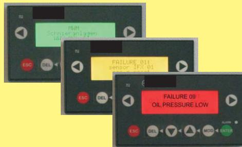
Programmazione semplice ed accessibile dei cicli di prelubrificazione e lubrificazione. Due uscite di controllo con due diversi livelli di errore. Il controllo può essere collegato al controllo numerico della macchina.
