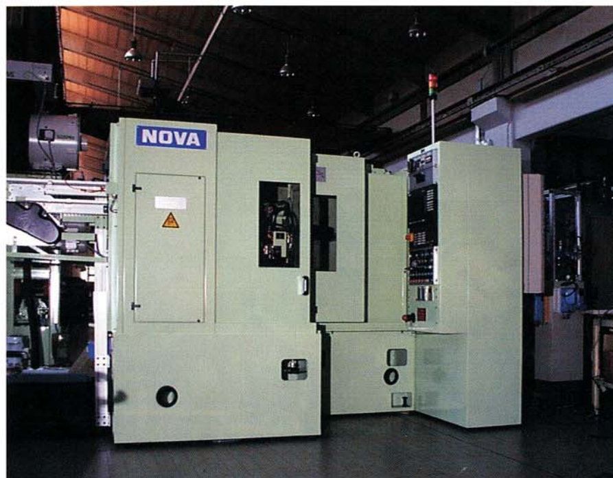
Figura 23 Rettificatrice per giunti omocinetiche RTF - U1/1TP/NG dotata di sistema di lubrificazione MQL per le guide lineari. Fabbricazione Meccanica Nova.
