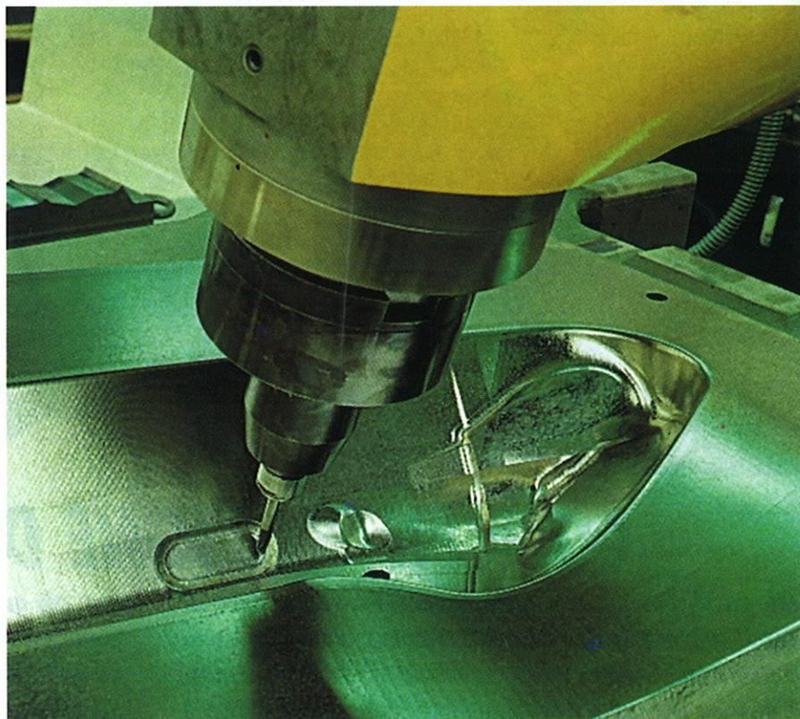
**Un progetto applicativo di lubrificazione aria-olio per mandrini di fresatura stampi, con l'integrazione di dispositivi di controllo automatico del dosaggio olio.**
