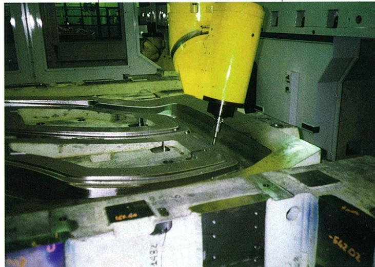
**Testa Twin con elettromandrino ad alta velocità in fase di lavorazione su stampo.**
