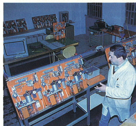
Reparto collaudo delle centraline di lubrificazione aria-olio MWM
