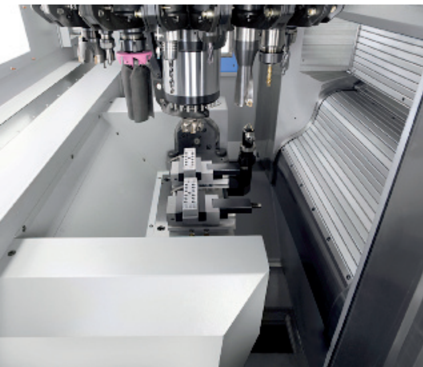
La nuova Chiron FZ 15W è un compatto centro di lavoro offerto con sistema opzionale MQL Lubrix, in combinazione e un magazzino a cesto con 20 posti utensile.
