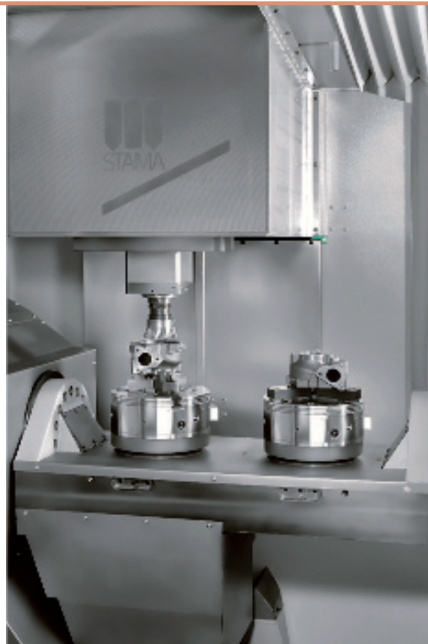
Macchina Stama di tornitura e fresatura integrata su 5 assi, la 834 MT dedicata alla produzione di lotti medio/bassi di componenti complessi da lavorare.
