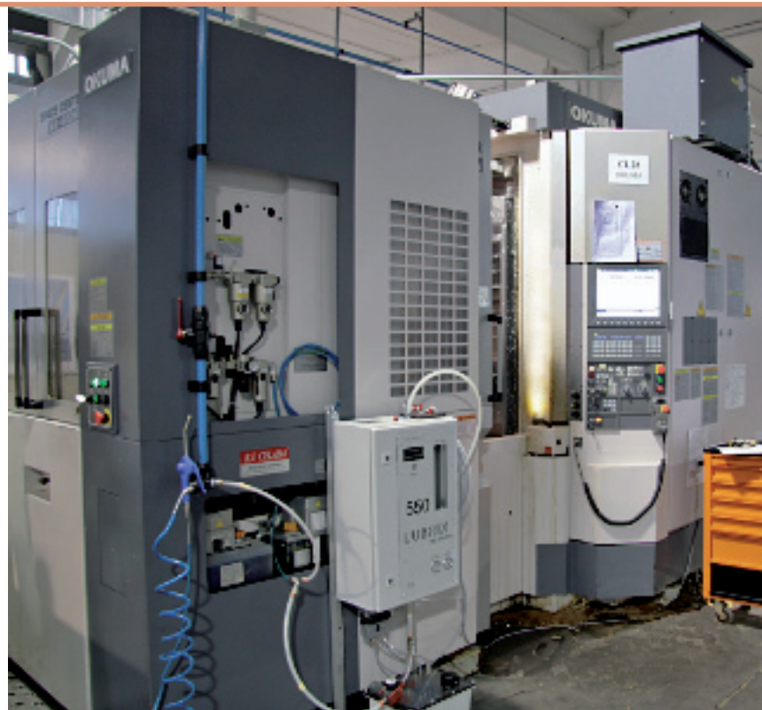
Sistema MQL Lubrix installato su centro di lavoro Okuma. Revamping su macchina funzionante sia con lubrificazione tradizionale che con MQL.
